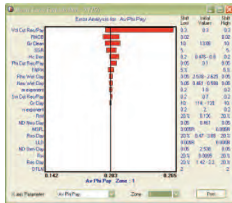
图中显示对地区平均孔隙度影响最大的是泥质含量边界值，像DTLN、Res Clay对结果毫无影响。
