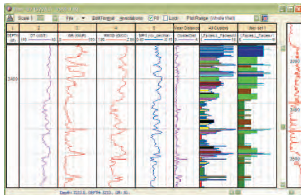
右边的曲线列表示电子相。最右边的曲线列是由15条原始的数据群重新组合成5种地质群组。
