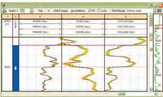
孔隙度、含水饱和度和泥质含量随深度变化错误趋势图。
